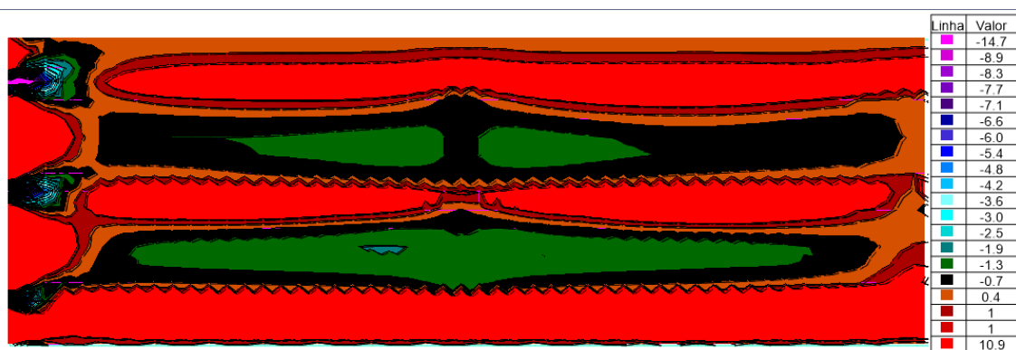
Figura 39 - Combinação última normal – Diagrama de momentos na direção Y
