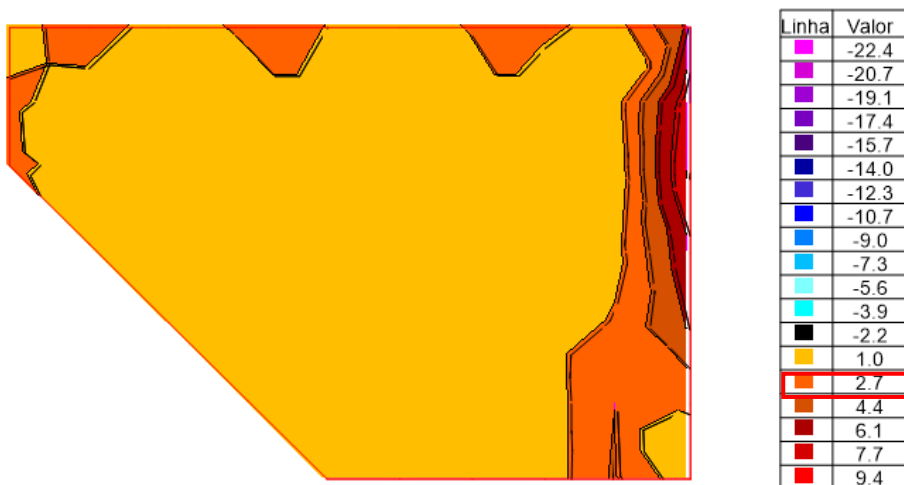
Figura 72 – Forças na direção Y – valor máx. cortante positivo = 9.4 tf e negativo 22.4 tf
