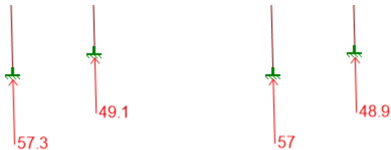
Figura 81 – Estaca de encontro - Envoltória máx. de combinações com CIV = 1 para geotécnico– Reação máx. = 57.3 tf
